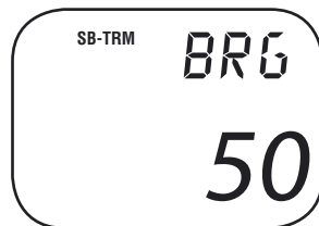
Einstellen des Bremsausschlags (Drehwähler A), S. 33 (nur verfügbar, wenn die Funktion „0“ für Kanal 3 gewählt wurde). Weiteres auf S. 34, Die Funktion Kanal 3
